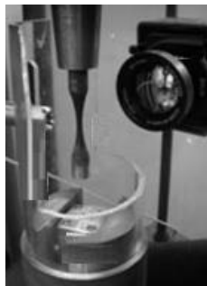
Figura 1. 14 Pruebas de fatiga por resonancia ultrasónica [16].
