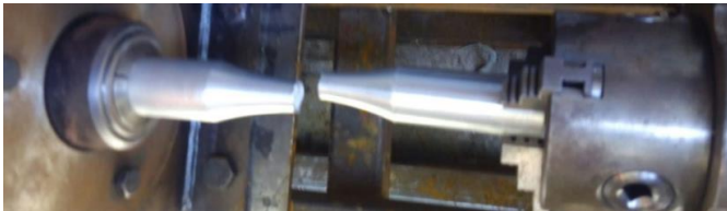
Figura 4. 9 Ruptura de probeta de aluminio 6061-T6
