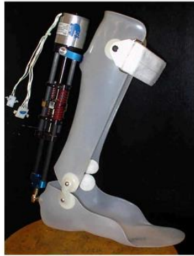
Figura 2.40. Active Ankle-Foot Orthoses (AAFO). Órtesis activa del MIT.
