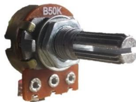
Figura 3.63. La referencia a partir de la cual se considera que la posición angular en el vástago del potenciómetro es de 0^\circ es cuando la ranura en el vástago se encuentra en posición horizontal, entregando un voltaje de 2.5 V.
