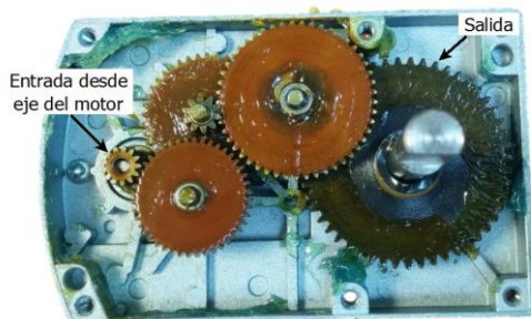
Figura 3.29. Tren de engranes acoplado al motor WINGXINE. La relación de transmisión es de 394:1.
