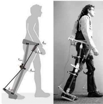
Figura 2.39. Concepto del exoesqueleto con tendones artificiales.
