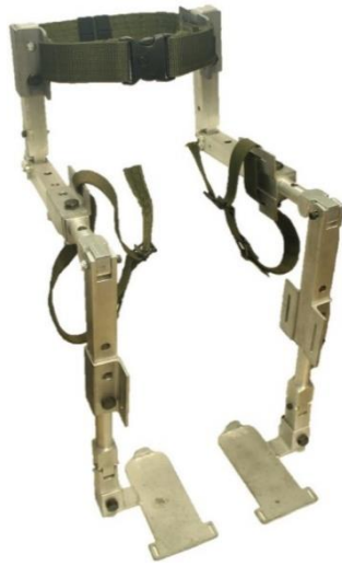
Figura 3.41. Ensamble completo de los eslabones del prototipo físico del exoesqueleto.
