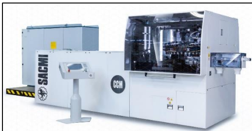
Figura 15. Método de Moldeo por compresión
