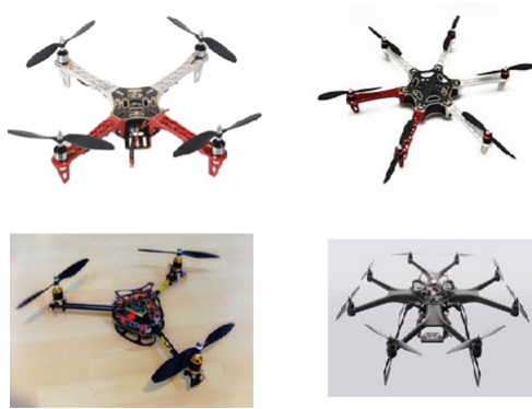
Figura 1.2.2: Cuadricóptero, Hexacóptero, Tricóptero y Octacóptero
