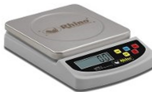
Figura A.0.1: Báscula digital Rhino de 0.2 g de resolución
