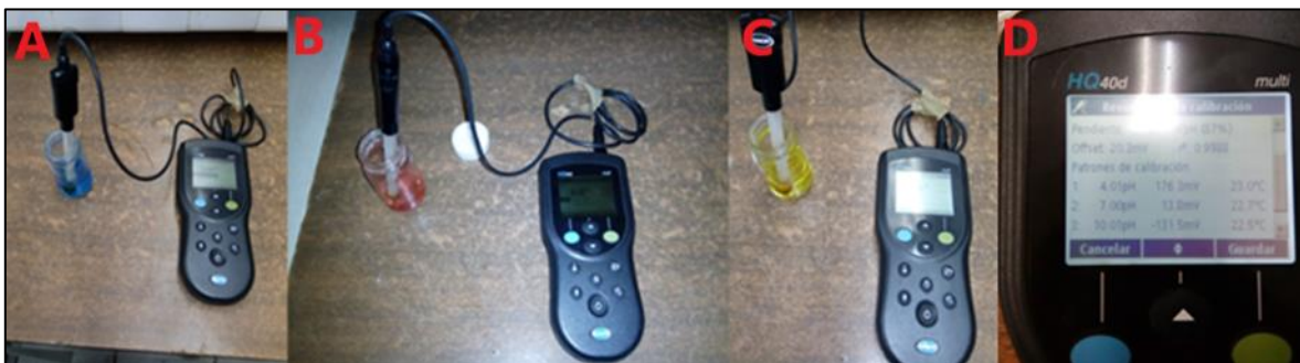
Fig. 19- Calibración de sonda de pH A), B), C) buffers empleados, D) detalle de a pantalla de la sonda
