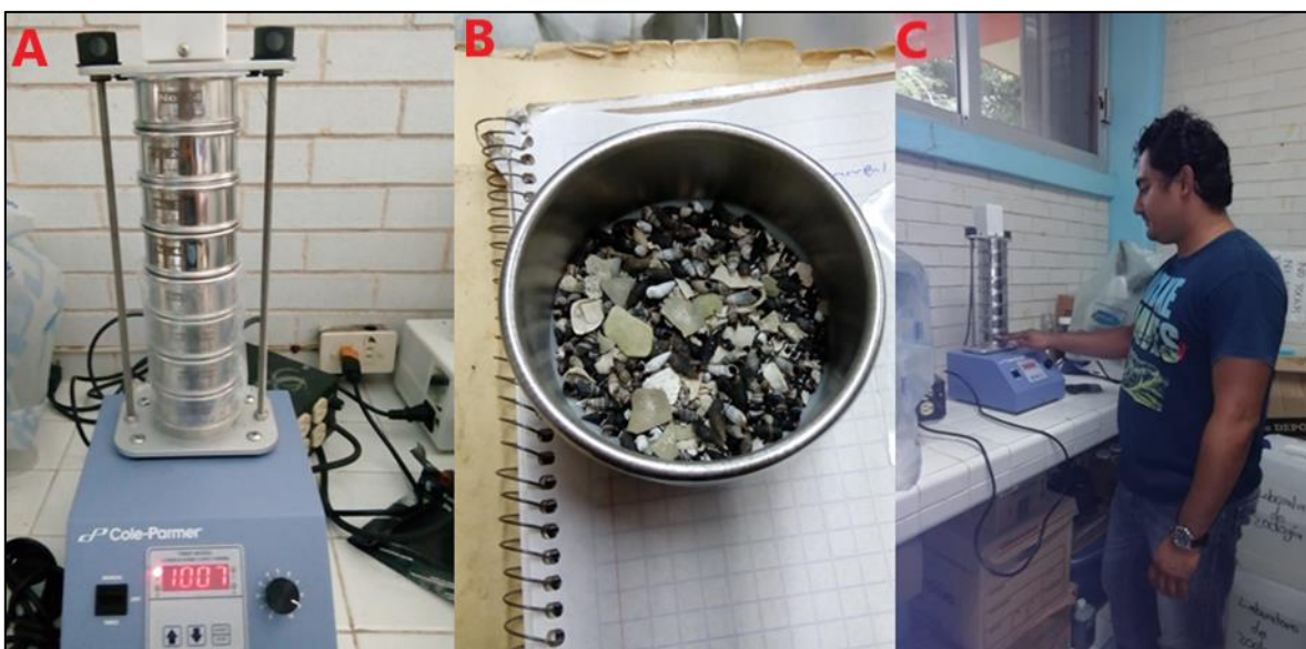
Fig. 20- Tamizado de las muestras para granulometría. A) Vibradora, B) detalle muestra tamizada, C) aspecto general del análisis.
