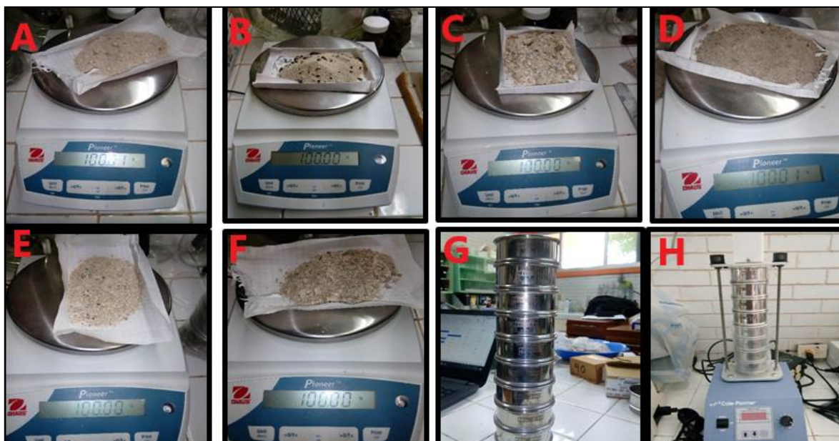
Fig. 7- Proceso para la obtención de la granulometría, (A-F) pesaje de las muestras, (G) colocación en los tamices, (H) tamizado de la muestra.
