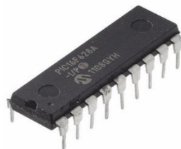
Ilustración 18 Microcontrolador pic 16f628A.
