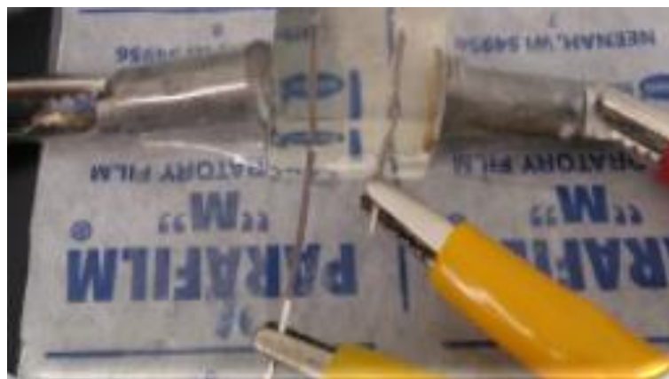
Ilustración 49 Celda electroquímica de cloruro de potasio con grenetina.
