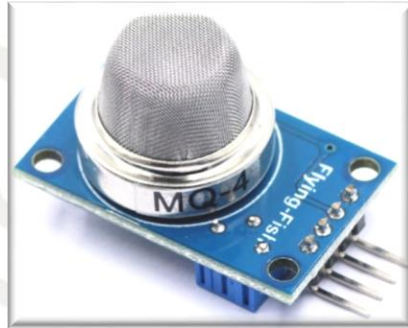
Imagen 3.34 Sensor MQ-4 para medición de gas metano
