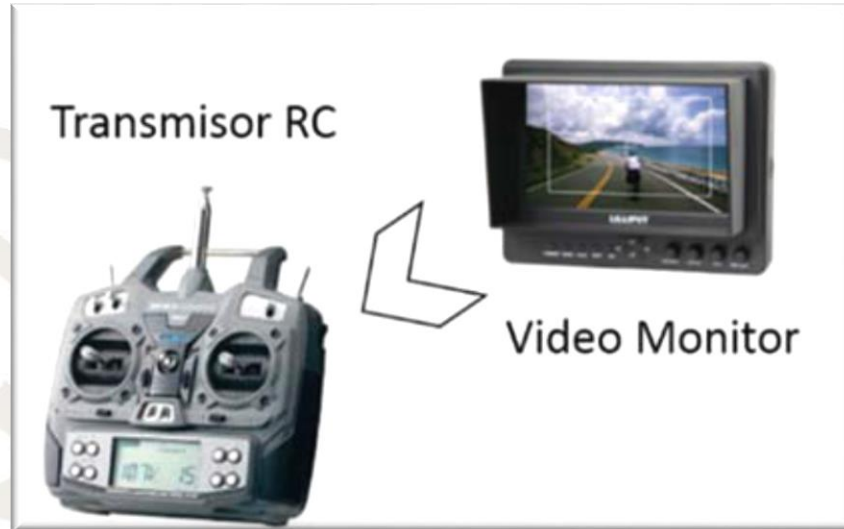
Imagen 3.2 Sistema de control y monitoreo.
