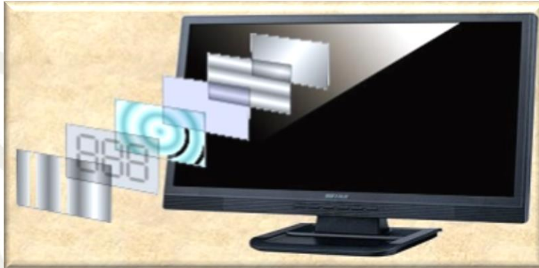
Imagen 2.15 Ejemplo de una pantalla LCD y las capas que la integran.
