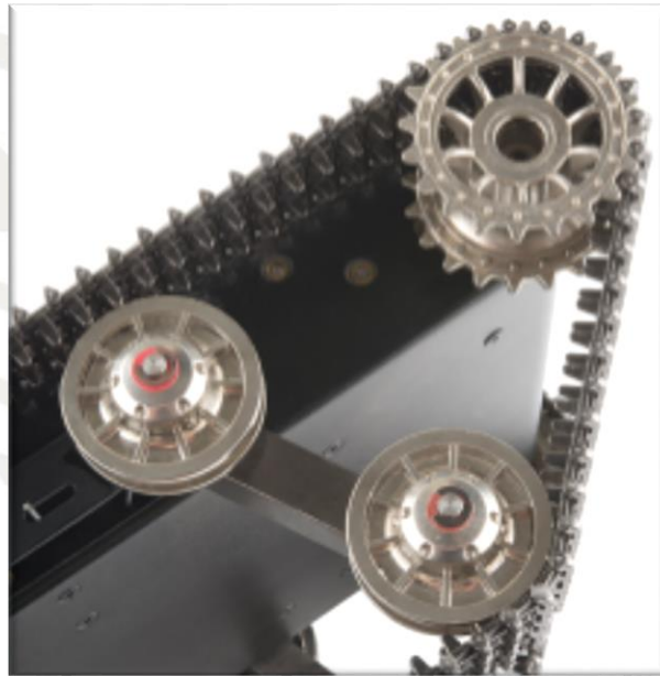
Imagen 3.5 Sistema de tracción y suspensión del chasis.
