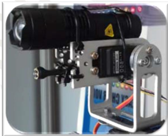
Imagen 3.16 Montaje del sistema para la cámara de video IR.
