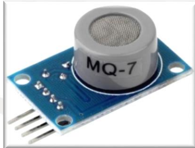
Imagen 3.36 Sensor MQ-7 para detección de monóxido de carbono (CO).
