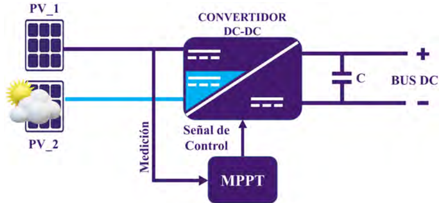
Figura 3.2: Esquema general de reconfiguración del sistema fotovoltaico en condiciones de sombreado parcial.
