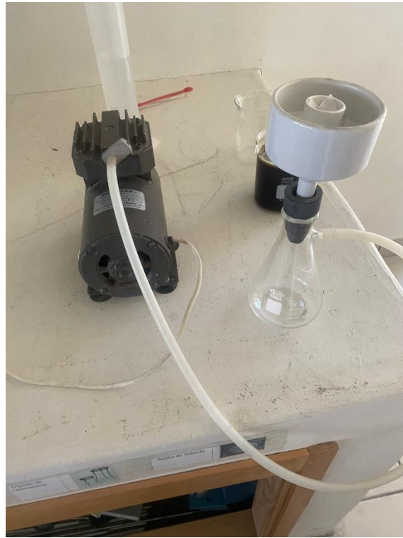
Figura 19. Montaje del sistema de filtración
