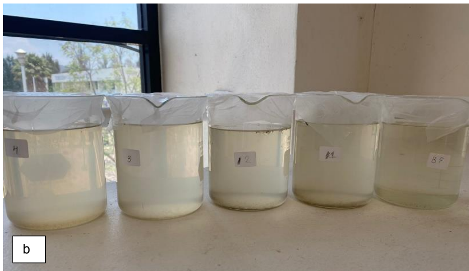
Figura 33. Experimento 2. a. Quitina [24 g/L] con muestra sin filtrar (BSF), b. Quitina [24 g/L] con muestra filtrada (BF)
