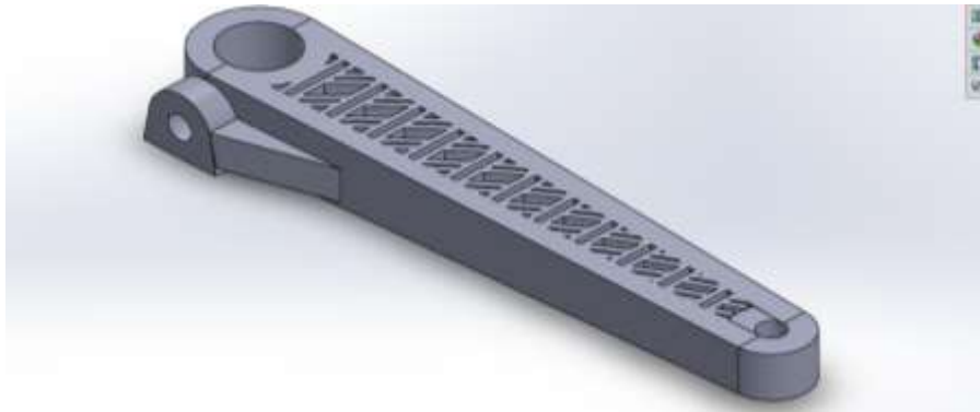
Figura 72. Manivela terminada con extrucción laminar (Diseño 13).
