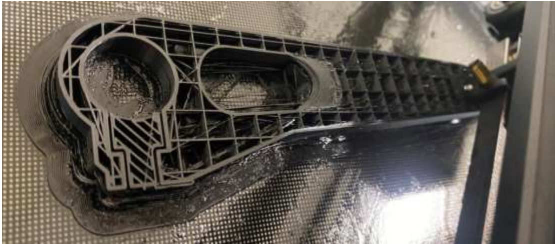
Figura 194. Implementación de falda o borde.
