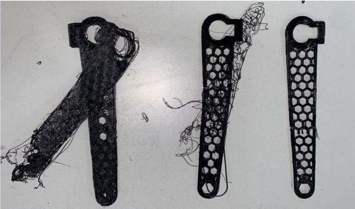
Figura 192. Errores de Impresión.
