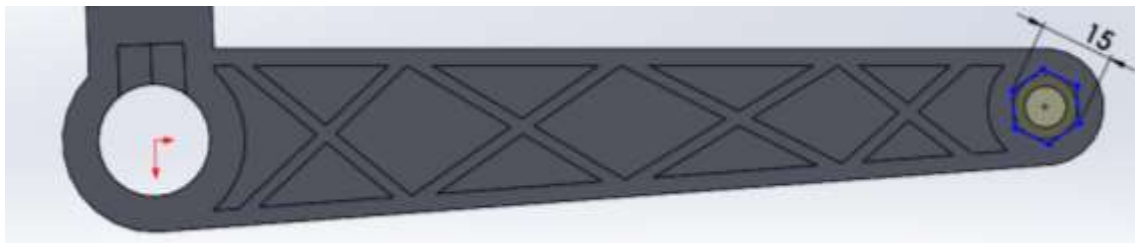
Figura 40. Corte en el cilindro menor de forma hexagonal (Diseño 1).
