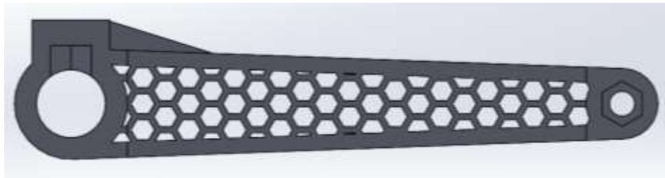
Figura 131. Manivela 4 – vista desde la planta.
