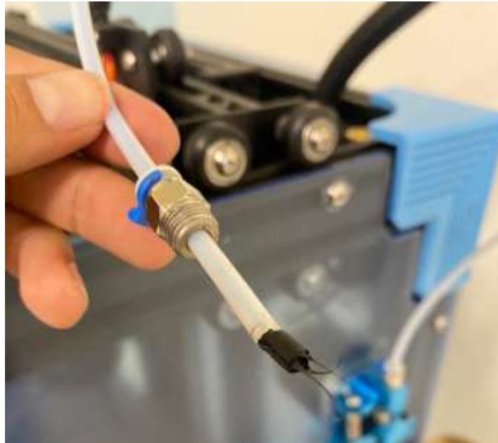
Figura 114. Obstrucción de filamento.
