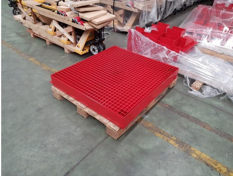
**Figura 6. Ejemplo de cubeta para batería**
