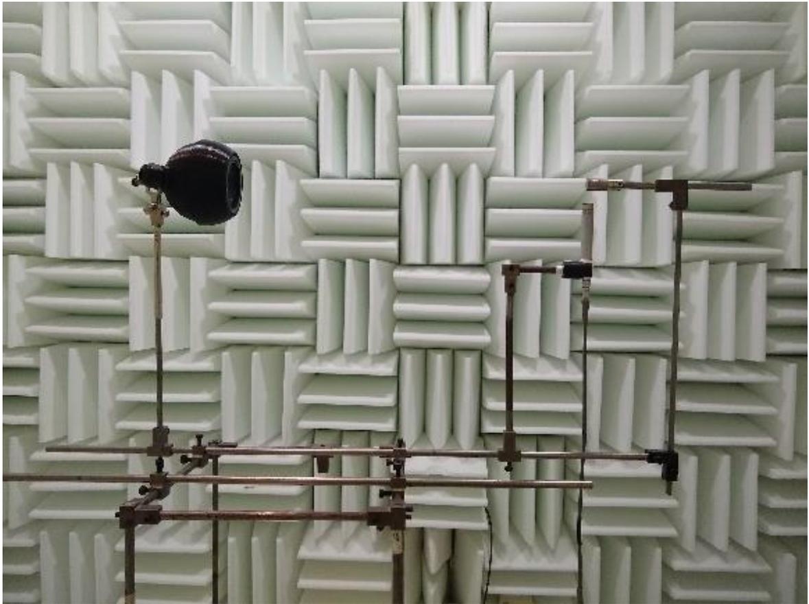
Figura 12. Arreglo para calibración en altas frecuencias en línea recta.
