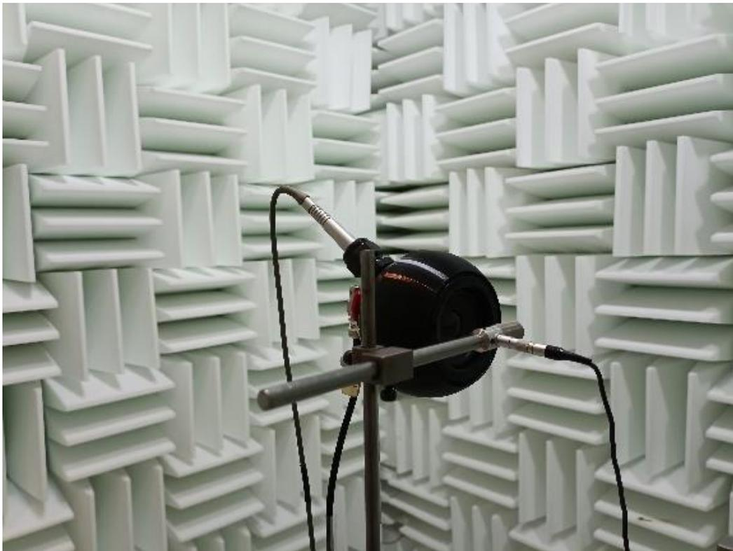
Figura 14. Arreglos para calibración en bajas frecuencias.
