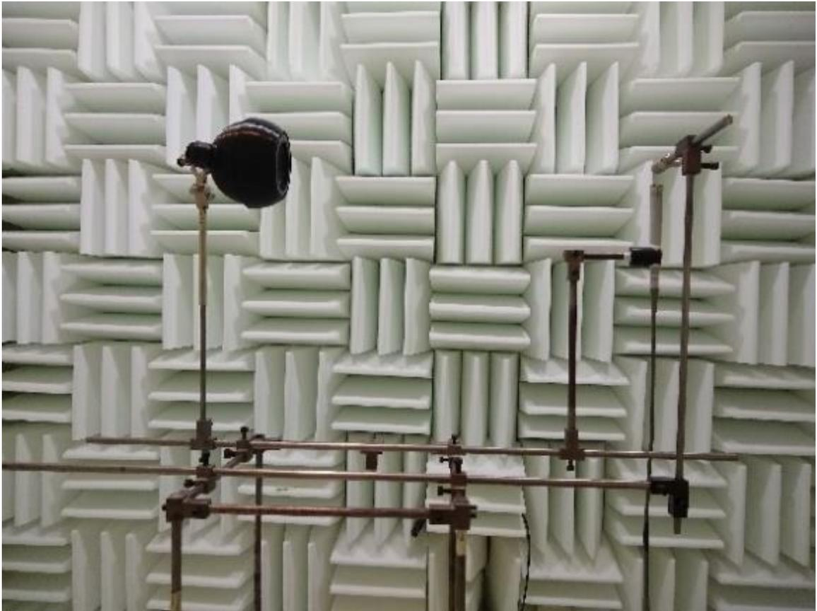
**Figura 13. Arreglo para calibración en altas frecuencias perpendicular.**
