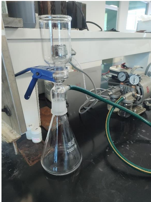
Figura 13 Proceso de filtrado Fuente: Elaboración propia
