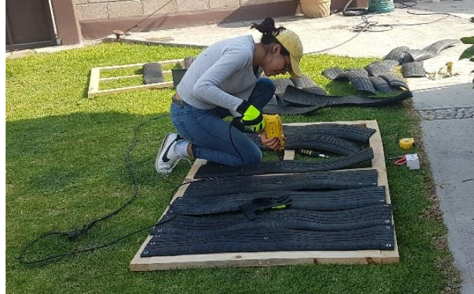
Figura 60. Colocación de lienzos de NFU en panel de madera (Ortega, 2019).
