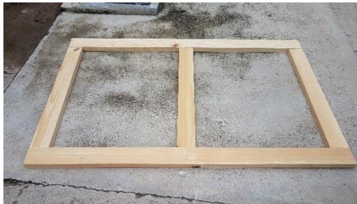
Figura 55. Estructura de madera engrapada (Ortega, 2019).
