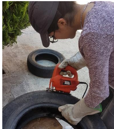
Figura 48. Corte de costado de llantas con uso de sierra caladora (Ortega, 2019).
