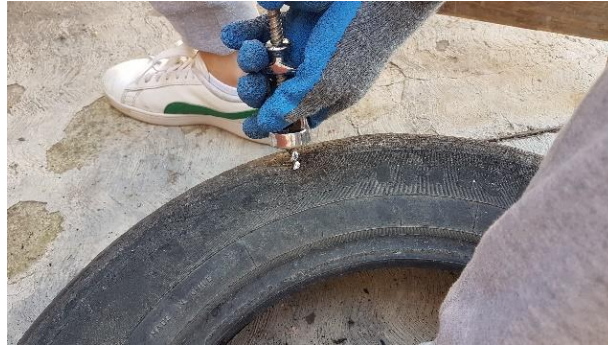
Figura 47. Perforación de neumáticos con sacacorchos o taladro (Ortega, 2019).
