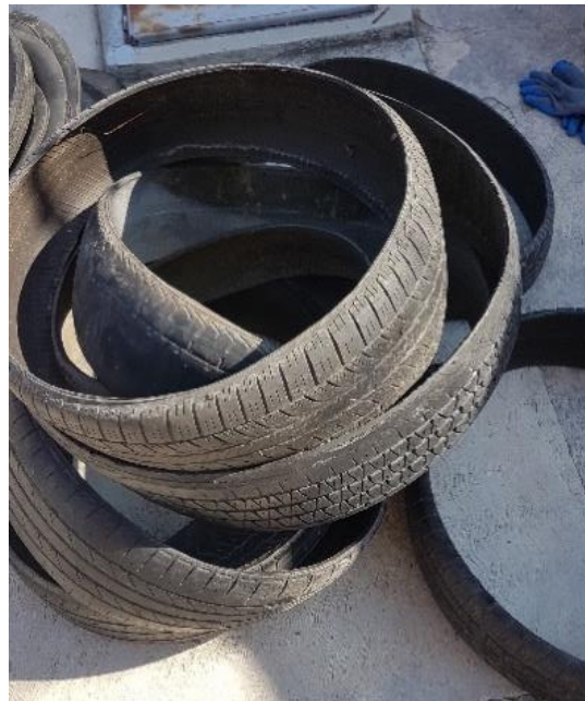
Figura 50. Neumáticos con ambos costados cortados (Ortega, 2019).
