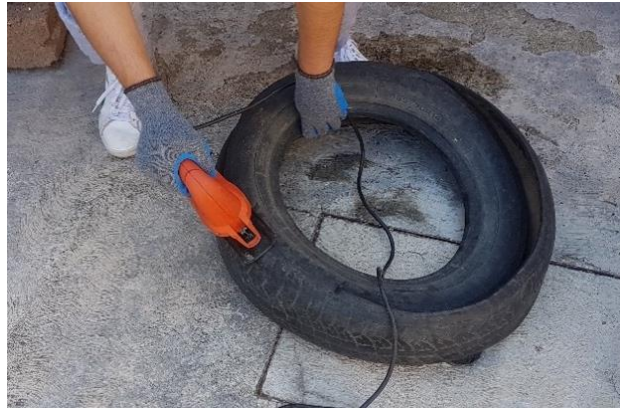
Figura 49. Corte de costado de llantas con uso de sierra caladora (Ortega, 2019).
