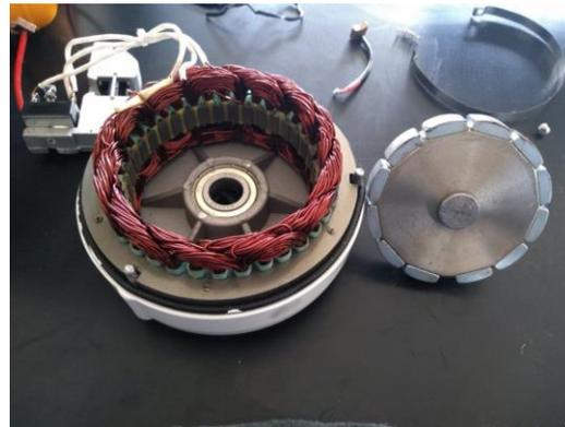
Fig. 41 Motor de aerogenerador.
