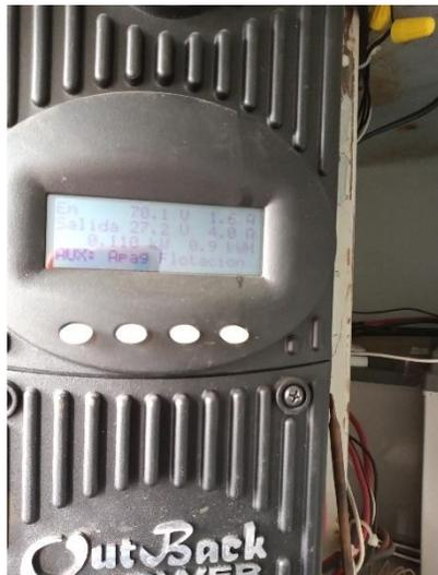
Fig. 24 Controlador de corriente y voltaje (OUT BACK POWER)
