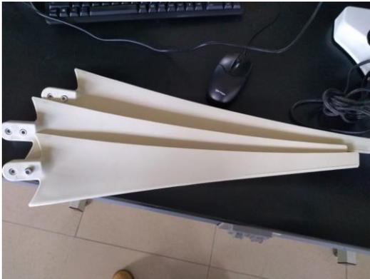
Fig. 40 hélices del aerogenerador.
