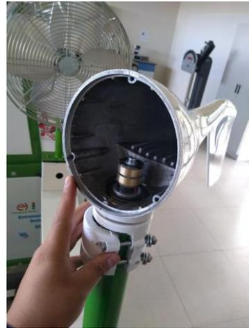
Fig. 39 Cuerpo del aerogenerador.
