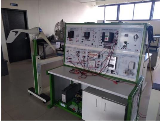
Fig. 38 Módulo híbrido de simulación de instalaciones fotovoltaicas y eólicas.
