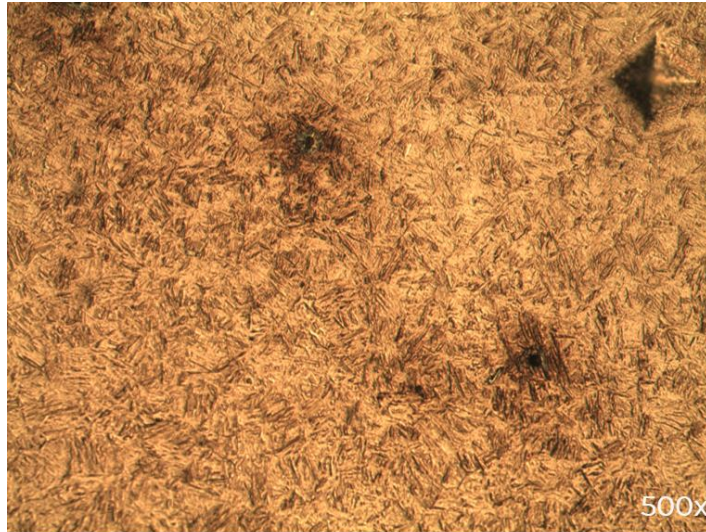
Figura 3.49 Microestructura probeta templada con fluido Nf U4.
