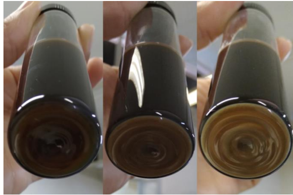
Figura 3.15 Seguimiento de sedimentación nanofluido con aceite usado al 0.5% m de Al_2O_3 , 0.1% m de S80 y 70°C, el día de preparación, 3, y 8 días después.
