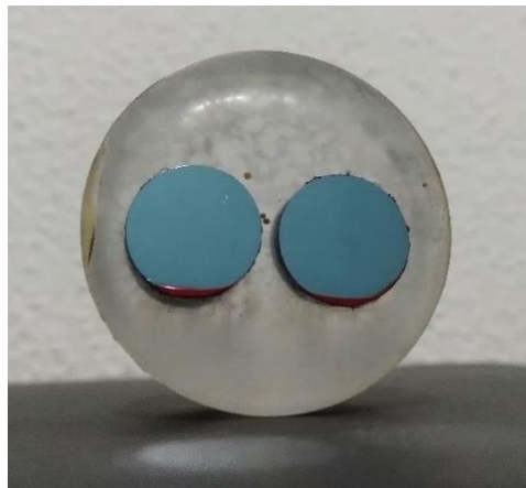
Figura 2.9 Probetas montadas, desbastadas y pulidas.
