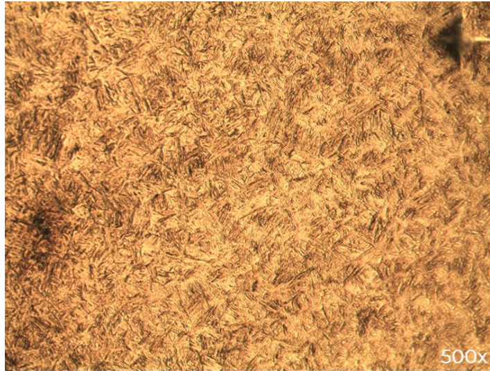
Figura 3.48 Microestructura probeta templada con fluido Nf U2.
