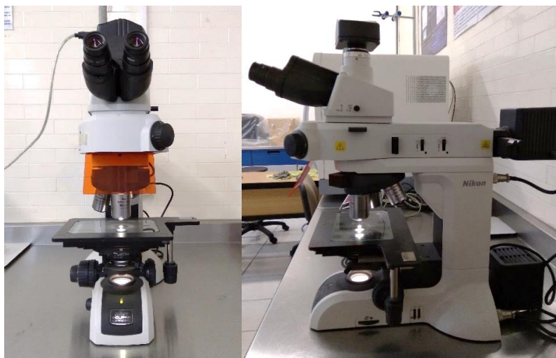
Figura 2.11 Microscopio óptico Nikon Eclipse LV100ND.
