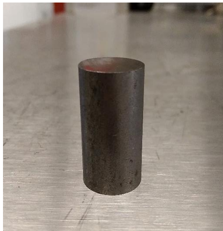
Figura 2.3 Probeta de acero 4140R.
