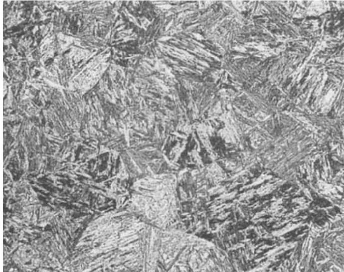
Figura 3.44 Microestructura típica de listones de martensita (Metals Handbook, 1998).
