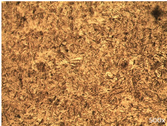
Figura 3.45 Microestructura probeta templada en aceite nuevo a 1200 rpm.
