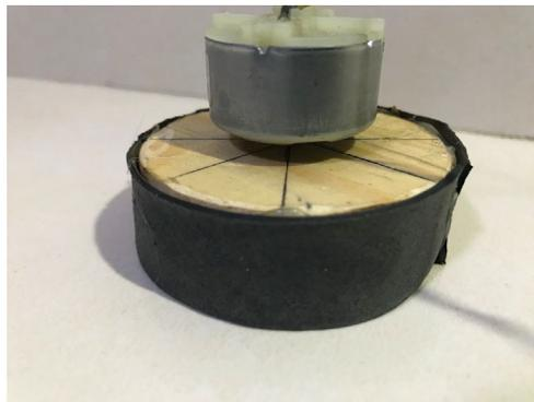
Figura 8: Eje del motor fijado en la perforación.
