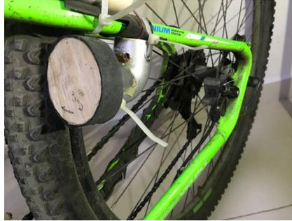
Figura 11: Rueda del dinamo en contacto con la llanta trasera de la bicicleta.
