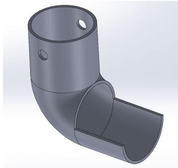
Figura 9: Perspectiva isométrica del tubo recortado y perforado.
