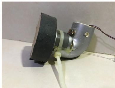
Figura 10: Dinamo acoplado con el soporte.
