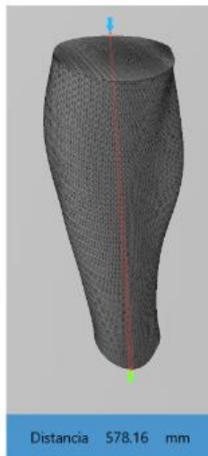
Figura 47 Longitud total de la pantorrilla, \pm 1 milímetro de tolerancia para vaciado.
