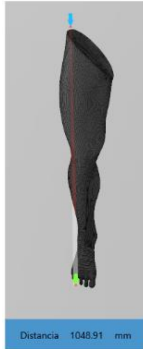
Figura 44 Medida de la pierna completa obtenida a través de fotogrametría
