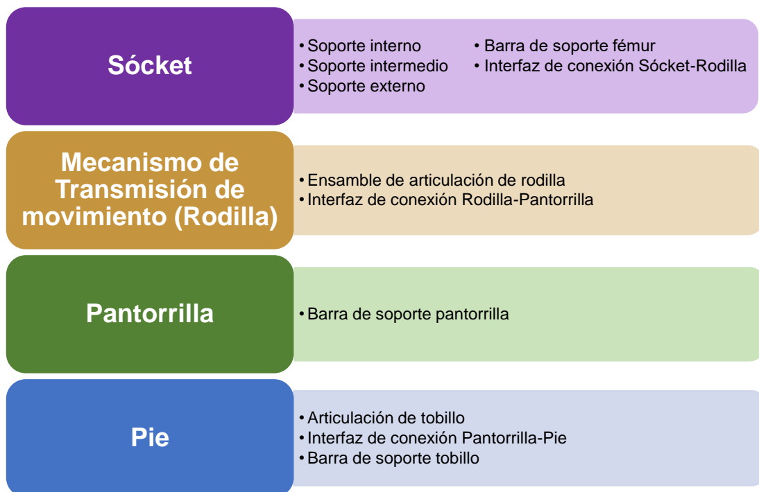
Figura 38 Módulos de una prótesis transfemoral
