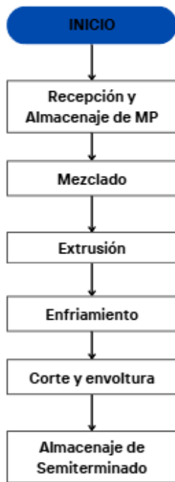
Figura 11: Diagrama de flujo del proceso de fabricación de Chicle 1. Elaboración propia
