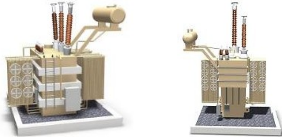
Figura 2.10.- Transformadores trifásico y monofásico.
