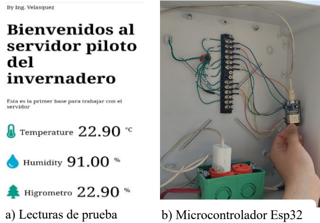
Figura 20. Conexión de sensores y microcontrolador con servidor piloto
