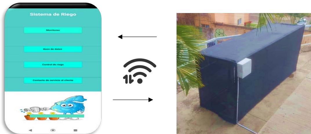
Figura 44. Monitoreo remoto del invernadero mediante internet de las cosas( IoT).
