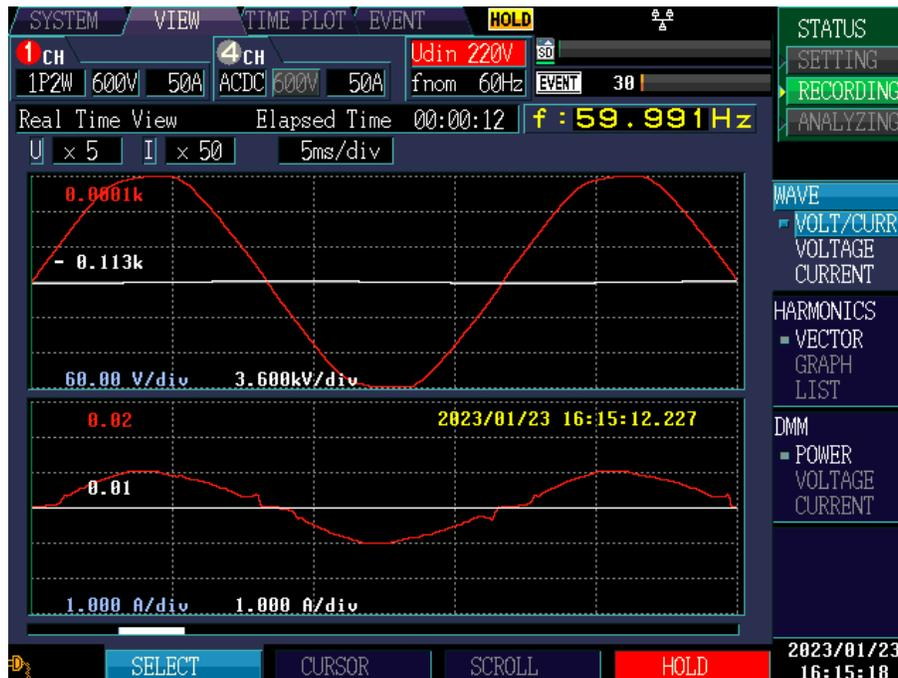
Figura 50. Corriente de la red medida con un analizador de espectro.
