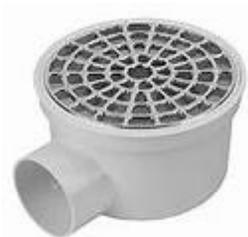
Se utilizará una coladera cospel de bote PVC debidamente colocada con una inclinación mínima de 2% para el desagüe de aguas grises en el patio de tendido.
