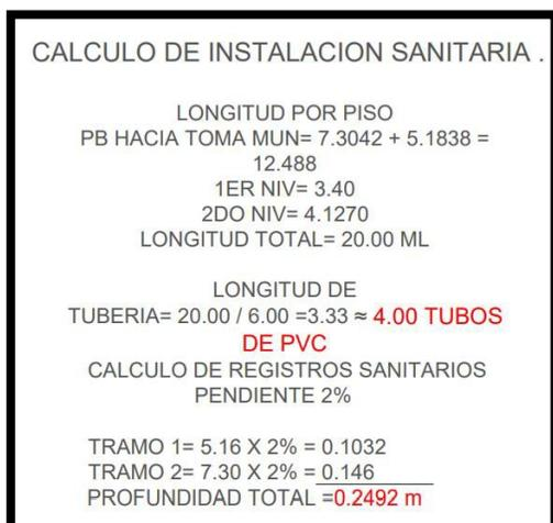
La conexión hacia colector municipal tiene un diámetro de 6" de tubería de PVC, para las tuberías interiores de muebles sanitarios de residuos de aguas negras es de 4" y de aguas grises es de 2" .
