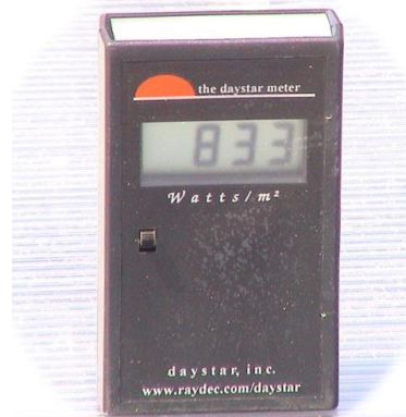
Figura 2.12.- Equipo que nos mide la Radiación solar directa al colector solar plano.
