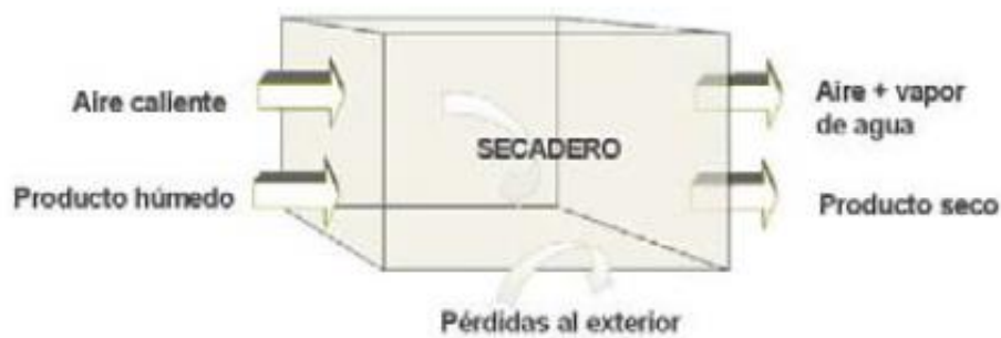
Figura 3.4.- Esquema de un proceso genérico de secado.
