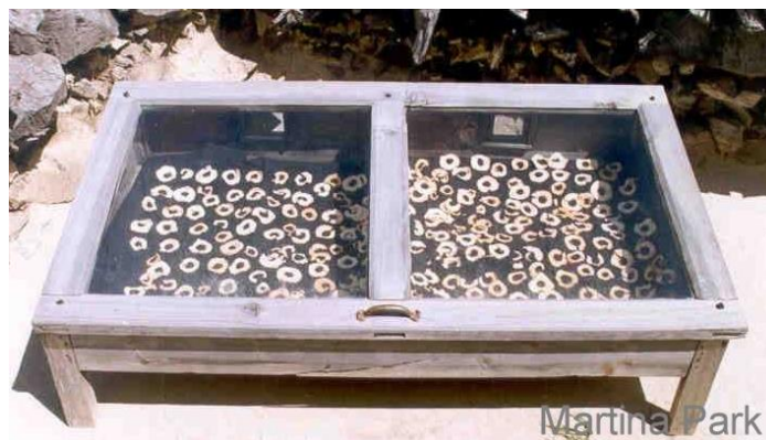
Figura 1.1.-Secador solar directo
