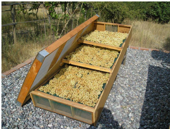
Figura 1.5.-Secador actual con la cubierta abierta para mostrar el interior
