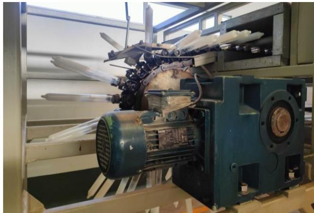
*Imagen 1.1.1. Motorreductor de la cadena de la línea de inmersión doble*
