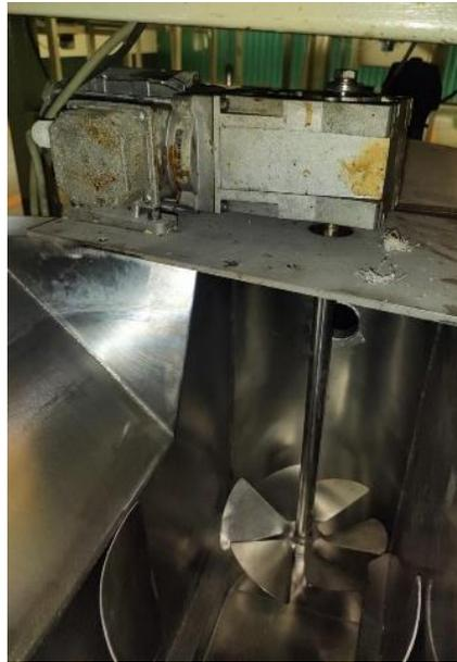
*Imagen 1.6.1. Agitador con el tanque de látex vacío*
