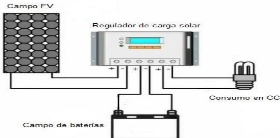
Diagrama 2.1 Conexión básica de un regulador de carga solar.
