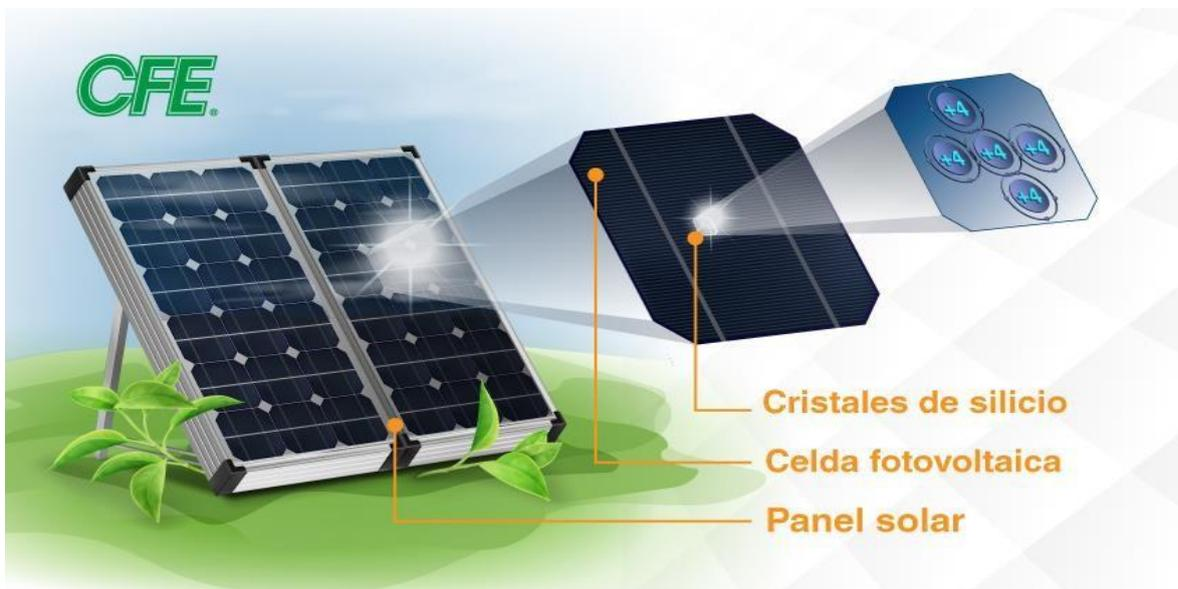
Figura 1.28 Un panel solar se conforma de celdas fotovoltaicas compuestas de cristales de silicio.
