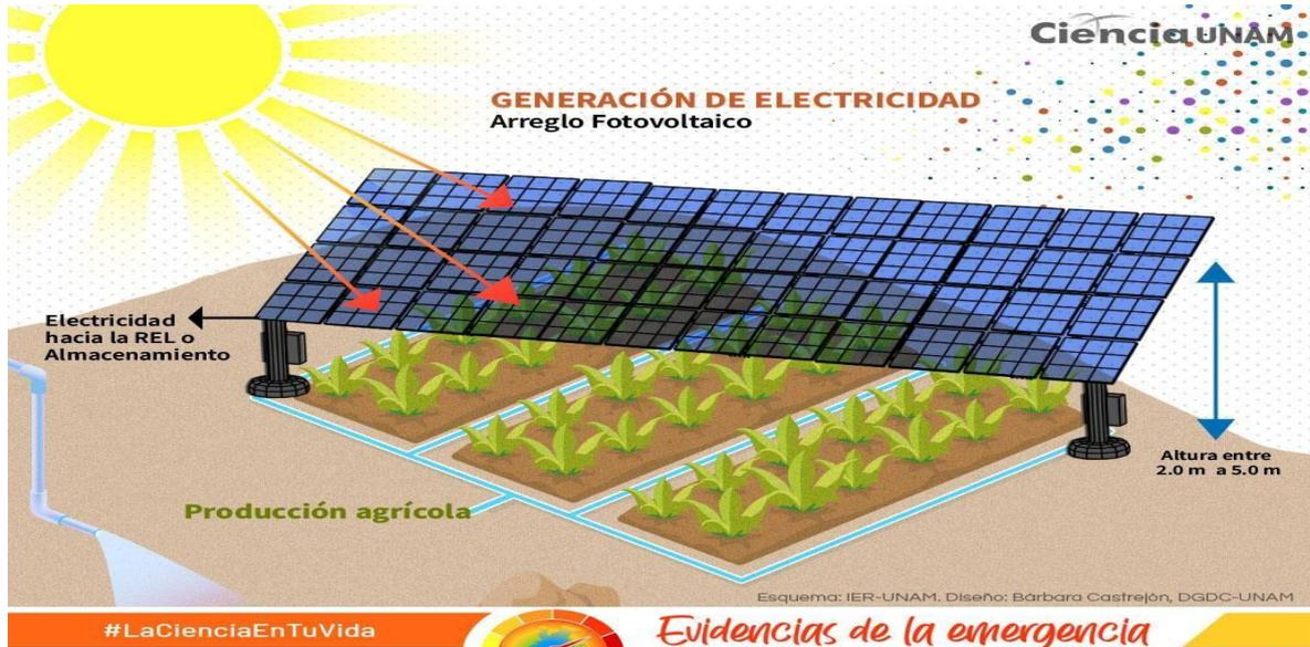
Figura 1.22 Arreglo fotovoltaico “Chinampas agrovoltaicas”.
