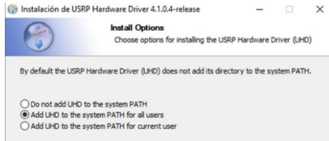
Figura 11. Instalación del binario UHD.
