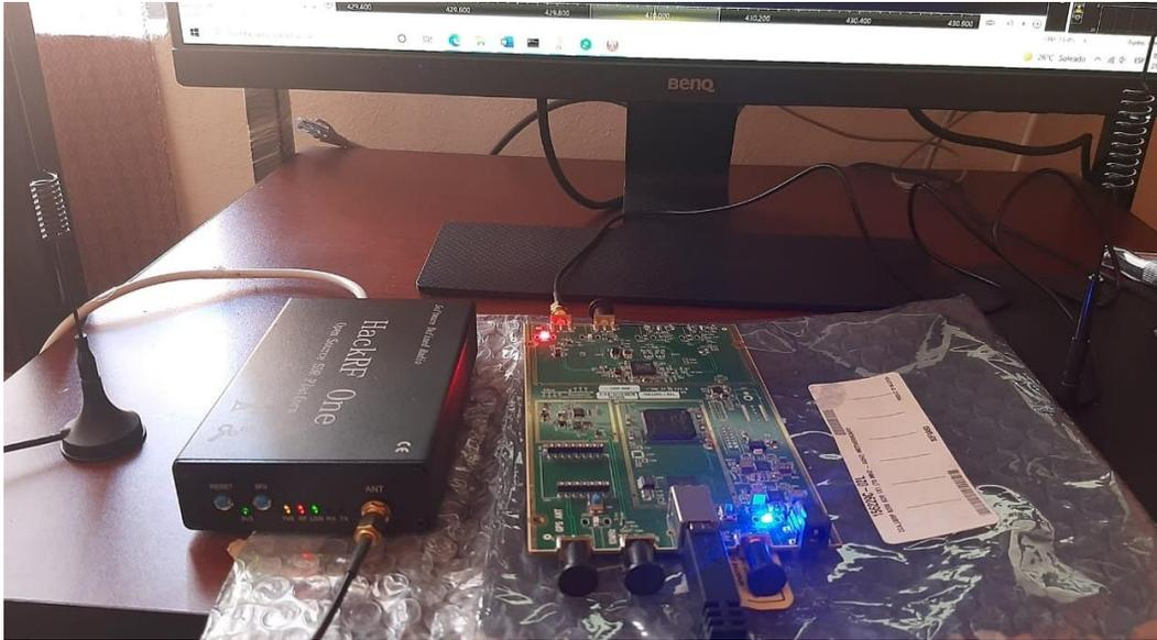
Figura 69. Tarjeta HackRF One en modo Receptor y Tarjeta USRP B200 en modo Transmisor.
