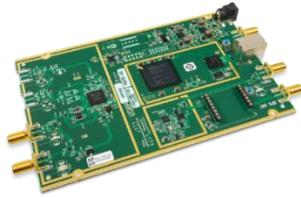
Figura 1. Ettus USRP B200: 1X1, 70 MHz-6 GHz SDR/Radio Cognitiva.
