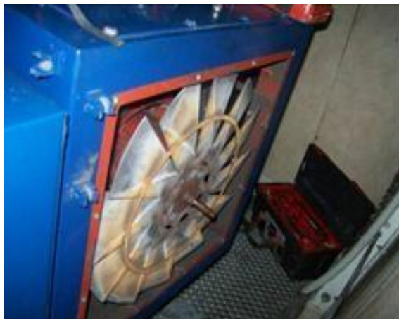
Figura 3.20 Desmontar el ventilador con la carraca de ¼
