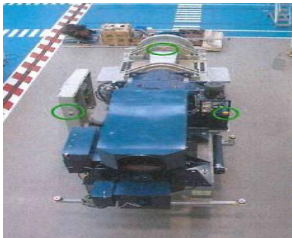
Figura 4.29 setas en la nacelle (top vertical)
