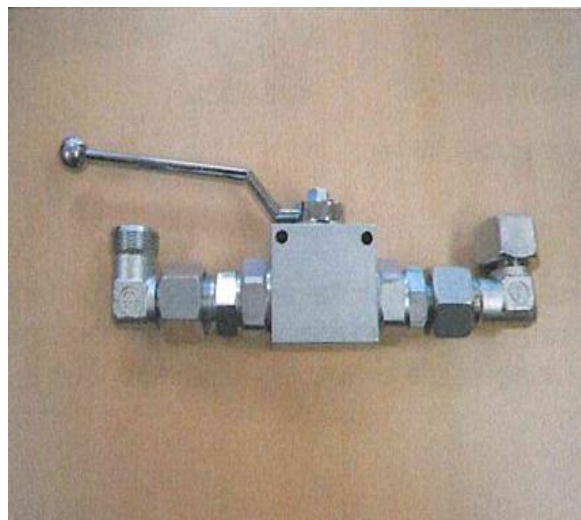
Figura 4.44 Detalle de la llave de bola
