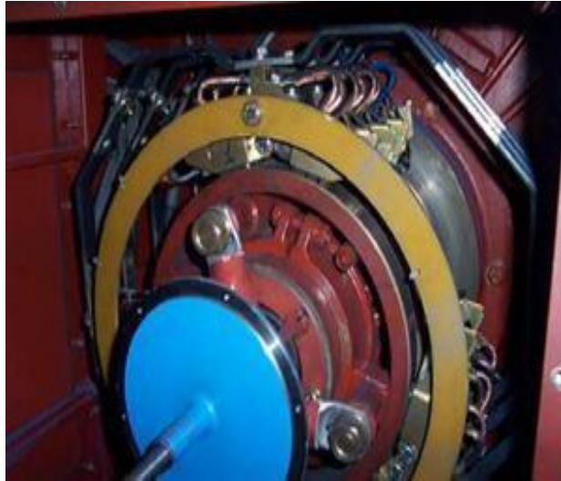
Figura 3.3 extraer el ventilador para poder acceder al cuerpo de anillos
