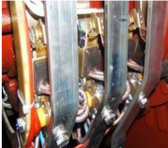
Figura 3.7 fijar las escobillas con el mecanismo de presión del portaescobillas
