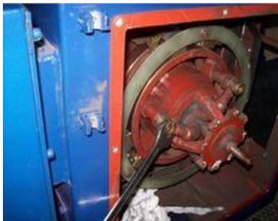
Figura 3.20 Desmontar el ventilador con la carraca de ¼
