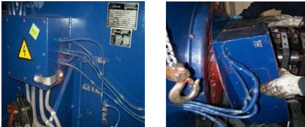
Figura 3.25 Desmontar la carcasa en la que van las resistencias calefactoras
