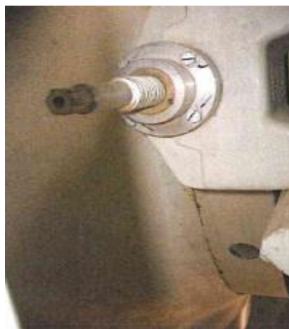
Figura 4.38 Detalle de uno de los bulones de bloqueo del eje lento.
