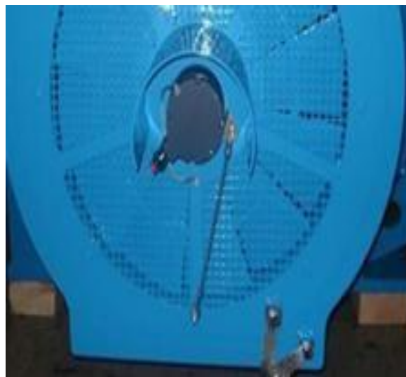
Figura 3.14 Soltar la tuerca del brazo de fijación del encoder.
