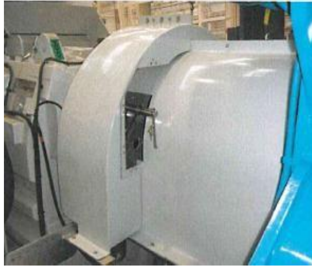
Figura 4.37 Última versión de resguardo de fibra: La ventana de bloqueo es fija y el bulón es más largo. No hay riesgo de atrapamiento ni siquiera en la operación de bloqueo porque no es posible introducir la mano.
