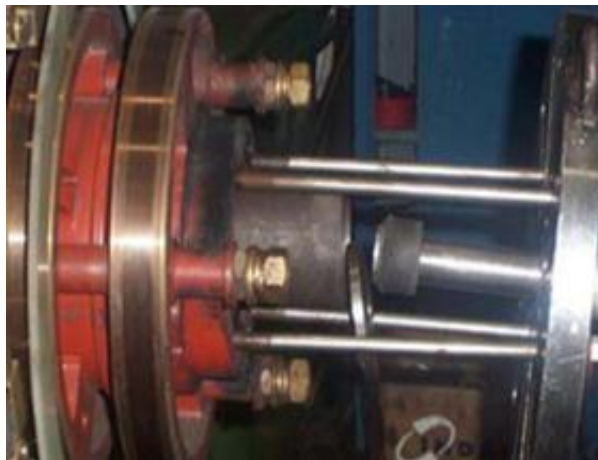
Figura 3.11 Retirar el cuerpo de anillo con un gato hidráulico
