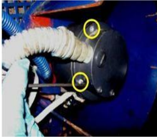
Figura 3.16 Mediante una llave allen de 3 mm quitar los cuatro tornillos de la tapa del encóder
