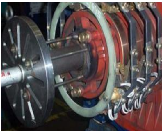
Figura 3.12 limpiar la superficie del eje para colocar el nuevo cuerpo de anillos.
