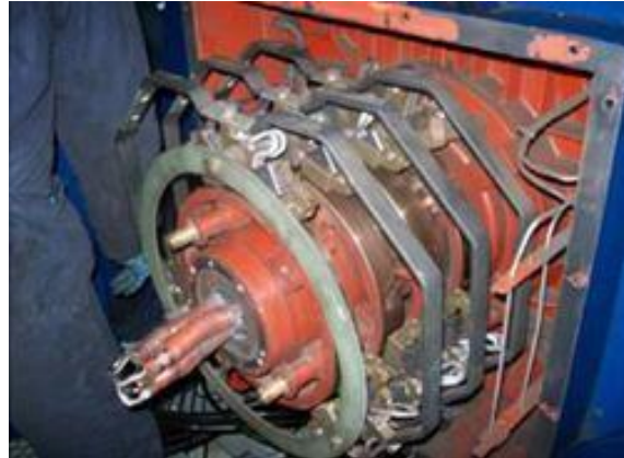
Figura 3.25 Desmontar la carcasa en la que van las resistencias calefactoras
