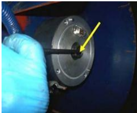
Figura 3.17 con una llave Allen soltar el tornillo del acoplamiento cónico
