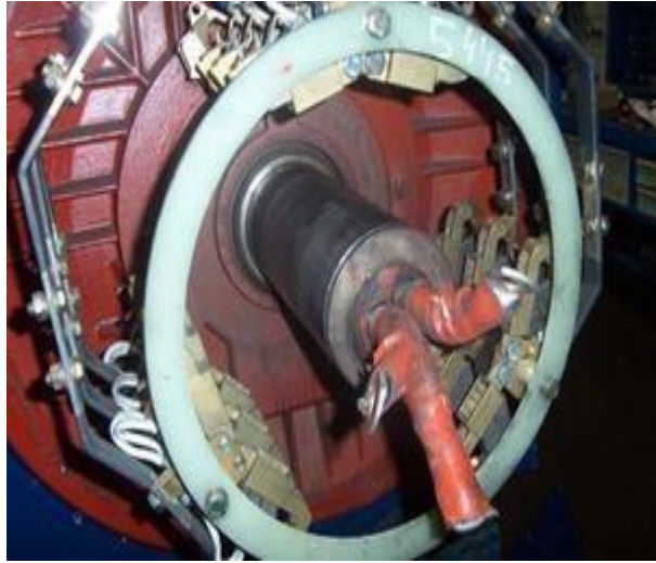
Figura 3.13 Aplicar en la superficie del eje una fina película de grasa para ayudar en la introducción del cuerpo de anillos.
