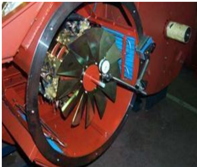
Figura 3.4 Colocar el ventilador en el eje y atar los tornillos de fijación.
