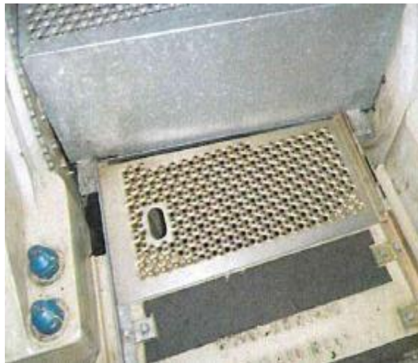
Figura 4.23 La trampilla de acceso a la nacelle está situada justo en el lateral derecho del caballete
