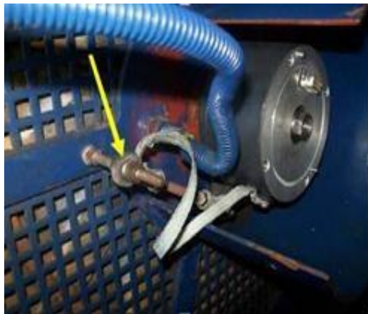
Figura 3.17 con una llave Allen soltar el tornillo del acoplamiento cónico
