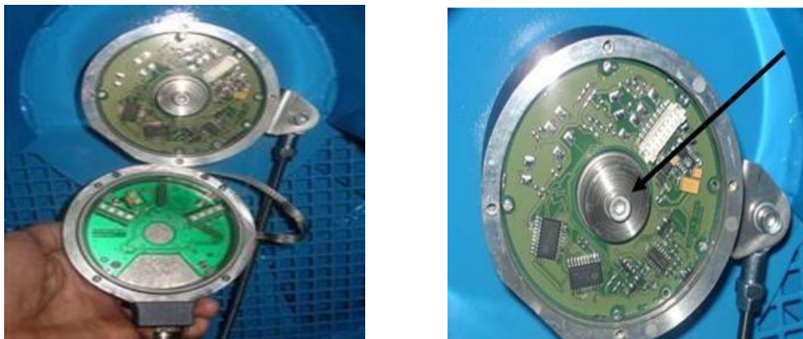
Figura 3.15 Soltar el tornillo Allen que amarra el encoder al eje y retirar el encoder con cuidado.
