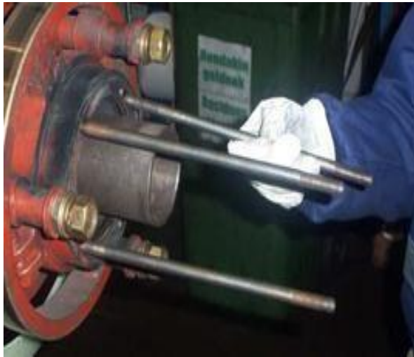
Figura 3.10 Fijar 4 varillas roscadas en los 4 agujeros
