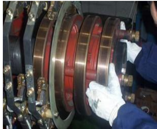
Figura 3.12 limpiar la superficie del eje para colocar el nuevo cuerpo de anillos.
