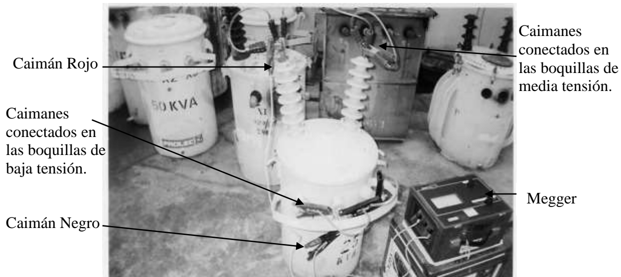
Figura 3.21 Prueba de un transformador de dos boquillas de alta tensión con tanque.
