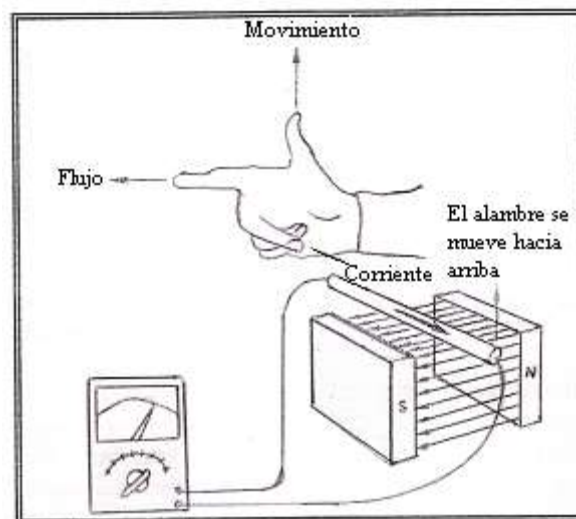
Figura 2.8 Regla de la mano derecha para determinar la dirección de la corriente inducida
