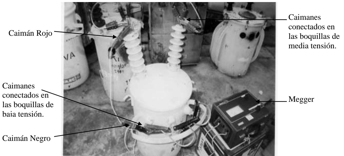
Figura 3.20 Prueba de un transformador de dos boquillas de alta con baja tensión.
