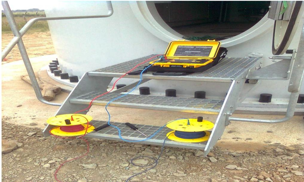
**Fig.31 Sistema de medición de tierra.**
