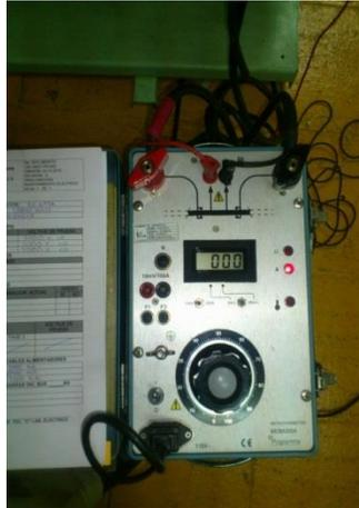
**Figura 4.16** Equipo DUCTER para realizar la prueba de resistencia de contactos.
