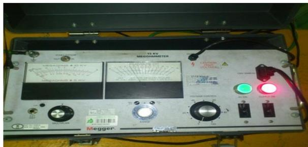
**Figura 4.18** Megger motorizado de 15 KV.
