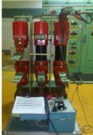
**Figura 4.17** Conexiones del ducter al interruptor
