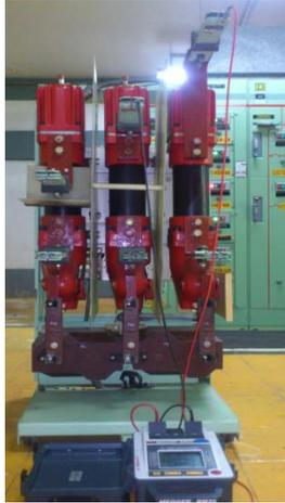
**Figura 4.19** Realización de la prueba de resistencia de aislamiento.
