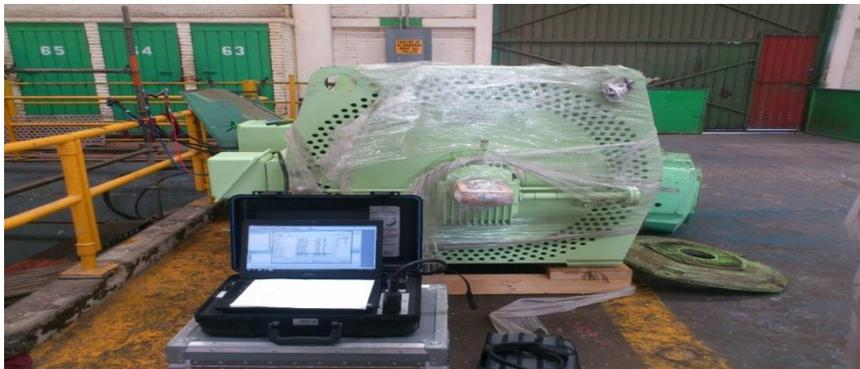
**Figura 4.22** Realización de la prueba con el equipo MCE MAX- PdMA
