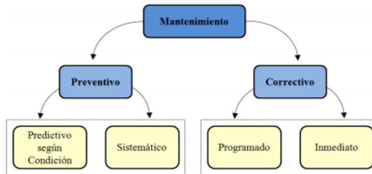
Figura 1-2. Tipos de mantenimiento según la norma EN-13460
