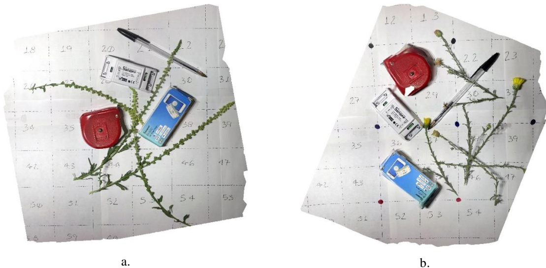
Figura 3.45: Ortomosaicos de 9 fotografías sin datos GPS a una altura de 32 cm con malla cuadriculada a) Sin puntos de referencia dibujados b) Con puntos de referencia dibujados (del autor).
