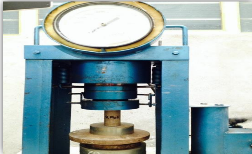
Figura 31.18. Prueba de compresión, (2024)
