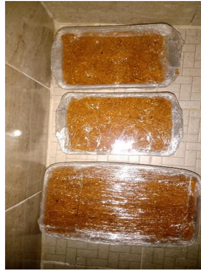
Figura 28.15. Moldes sellados con film plástico transparente, (CGRG, 2023).
