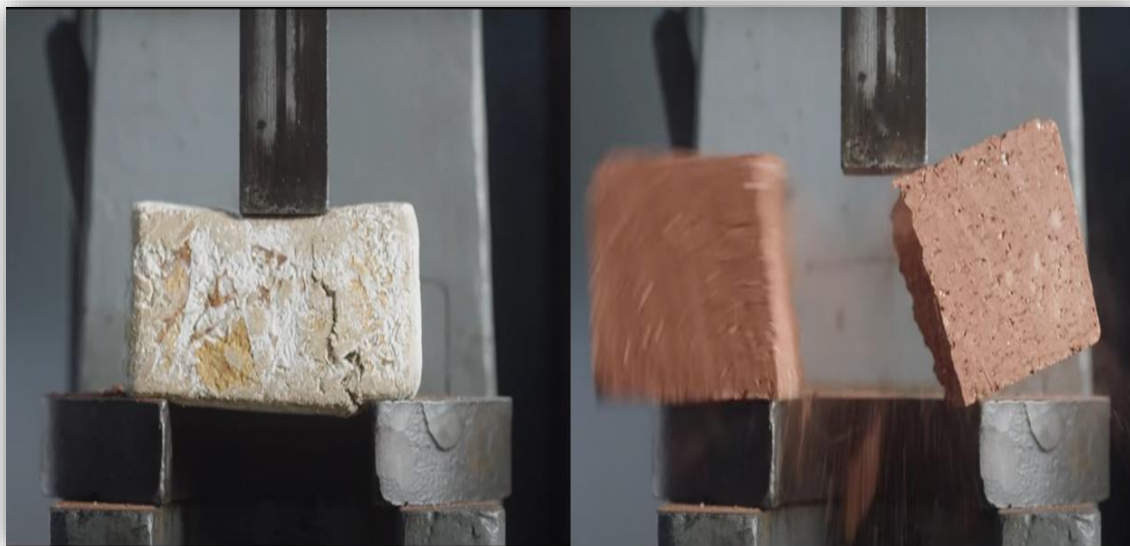
Figura 32.19. Comparación de prueba de compresión bloque de micotectura y bloque de concreto, (Philip Ross, 2018).
