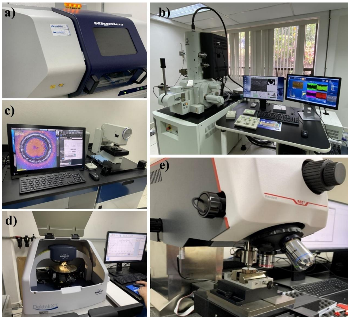
Figura 18. Equipo experimental: a) Difractómetro de rayos x, b) SEM/EDS, c) Microscopio óptico confocal, d) perfilómetro de contacto y e) Durómetro/probador de adherencia.
