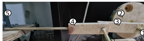
Figura 3.3: Mecanismo biela-manivela: 1- Masa de acero vaciado, 2- Manivela, 3- Biela, 4- Corredor, 5- Estructura.
