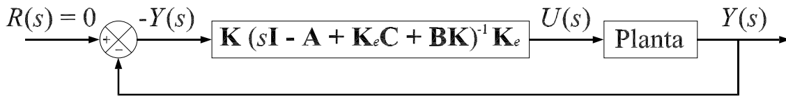
Figura 2.1: Diagrama de bloques del observador de estado de orden completo y el sistema, en el caso de que la entrada u y la salida y se consideran como escalares.
