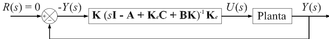
Figura 2.3: Representación en diagramas de bloques el sistema controlador-observador
