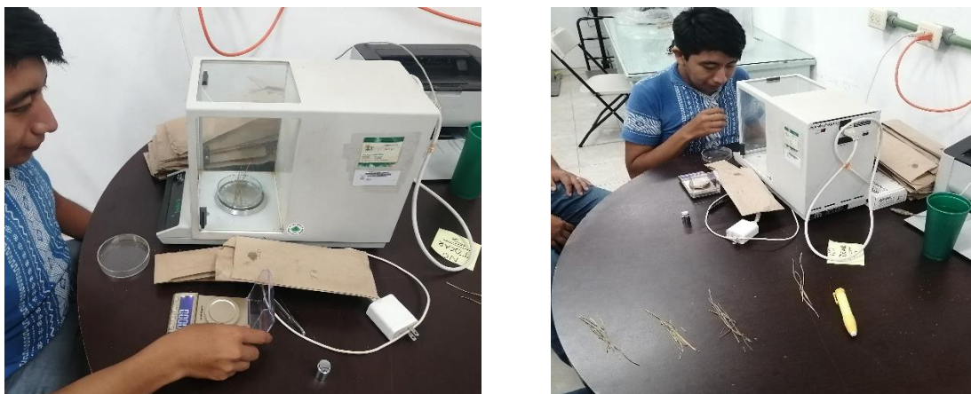
Figura 17. Panorámica del uso de la balanza digital para la obtención del peso seco de raíz, tallo y hojas de las plántulas de líneas y variedades de arroz.
