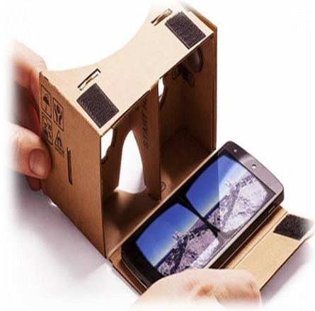
Figura 2.13. Google Cardboard, dispositivo que no tiene un visor incorporado. [44].
