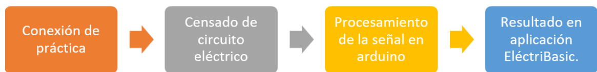
Figura 3.66 Diagrama de flujo de procesamiento de sensado de módulo de prácticas.
