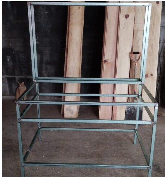
Figura 3.70 Construcción del esqueleto de PTR de 3/4 “
