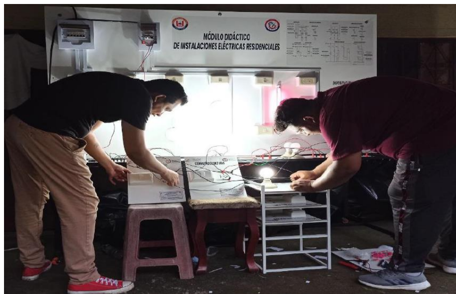
Figura 2.14 Ejecución de los circuitos que se propusieron para las prácticas a realizar. Fuente: Piñaloza y Rosado en 2022. Implementación de un módulo didáctico de instalaciones eléctricas residenciales para el laboratorio de la carrera de Ingeniería Electromecánica de la Universidad Técnica de Cotopaxi extensión la Maná.
