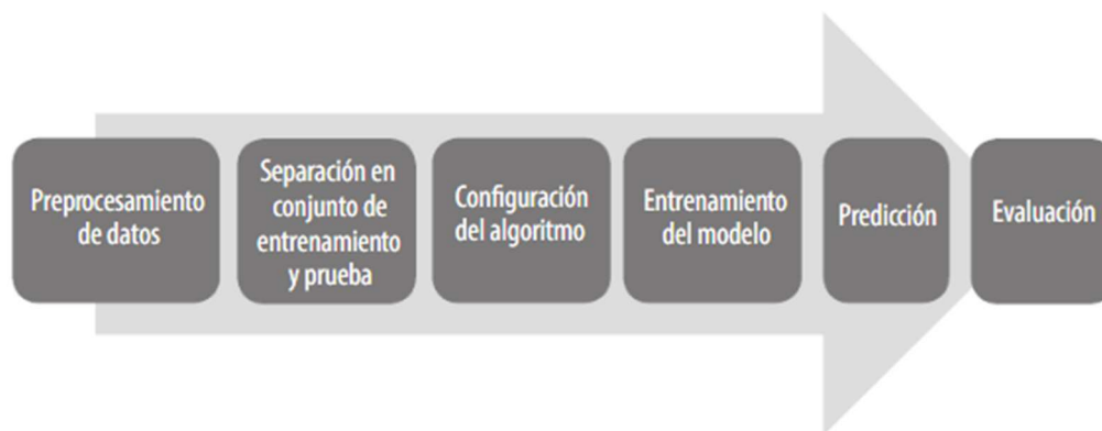
Fig. 3.1 Procedimiento para obtención del modelo de aprendizaje automático
