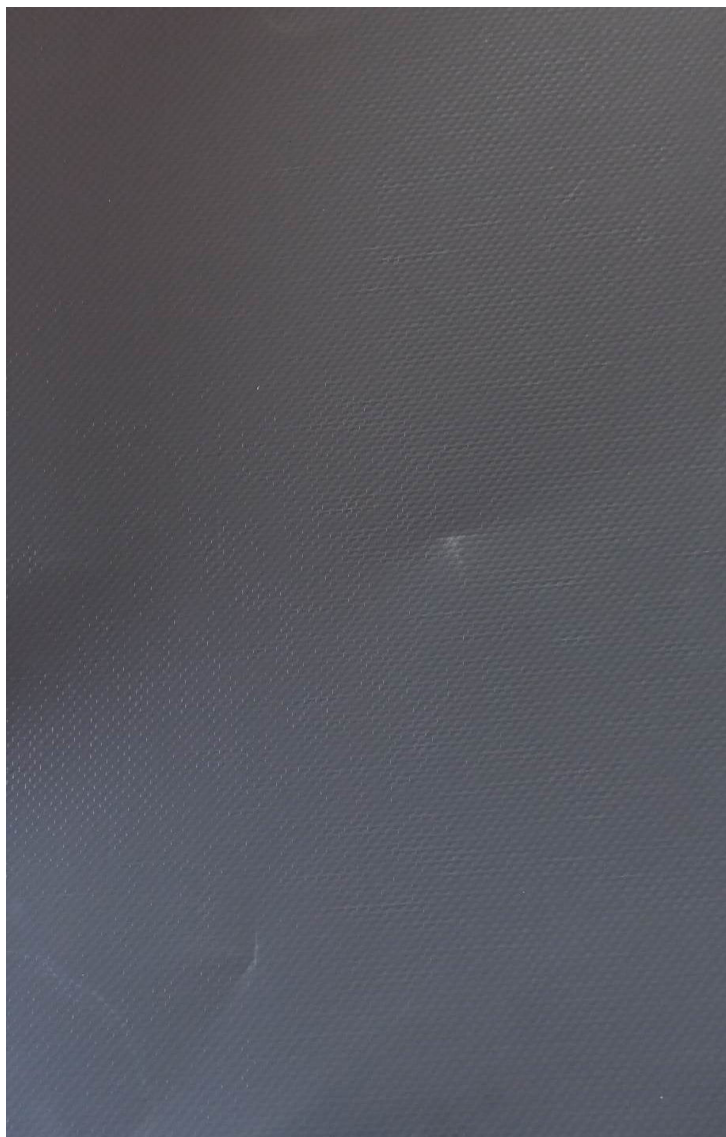
Ilustración 10 Defecto Lona Quemada de Plastificado
