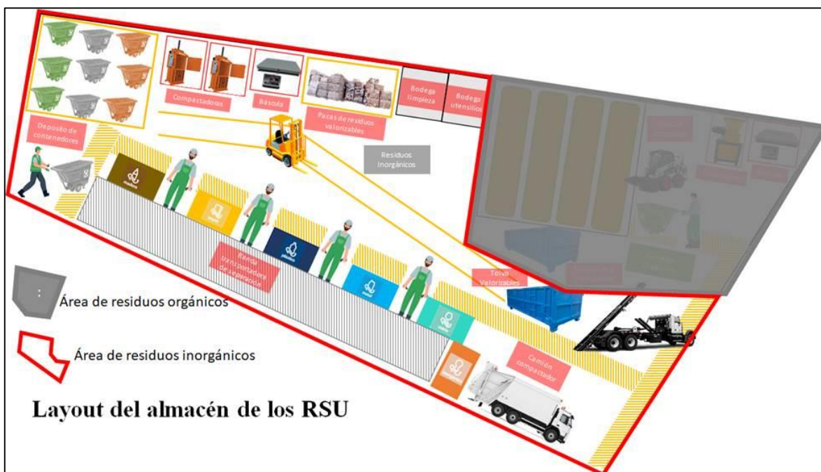
Figura 30. Croquis de ubicación de la banda para separar los RSU.
