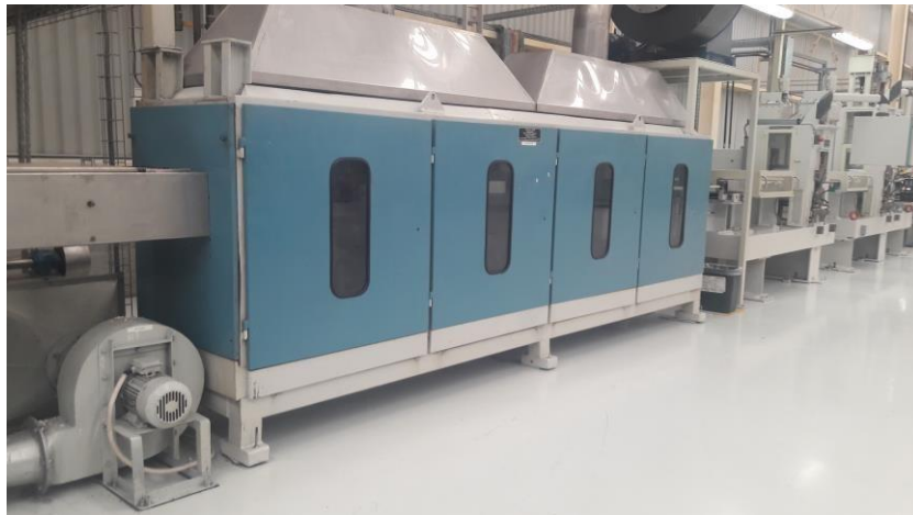
Ilustración 27 Cabina de enfriamiento
