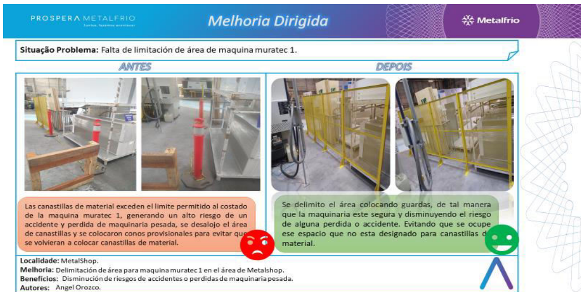
Ilustración 42. Limitación de área en maquinaria Muratec.
