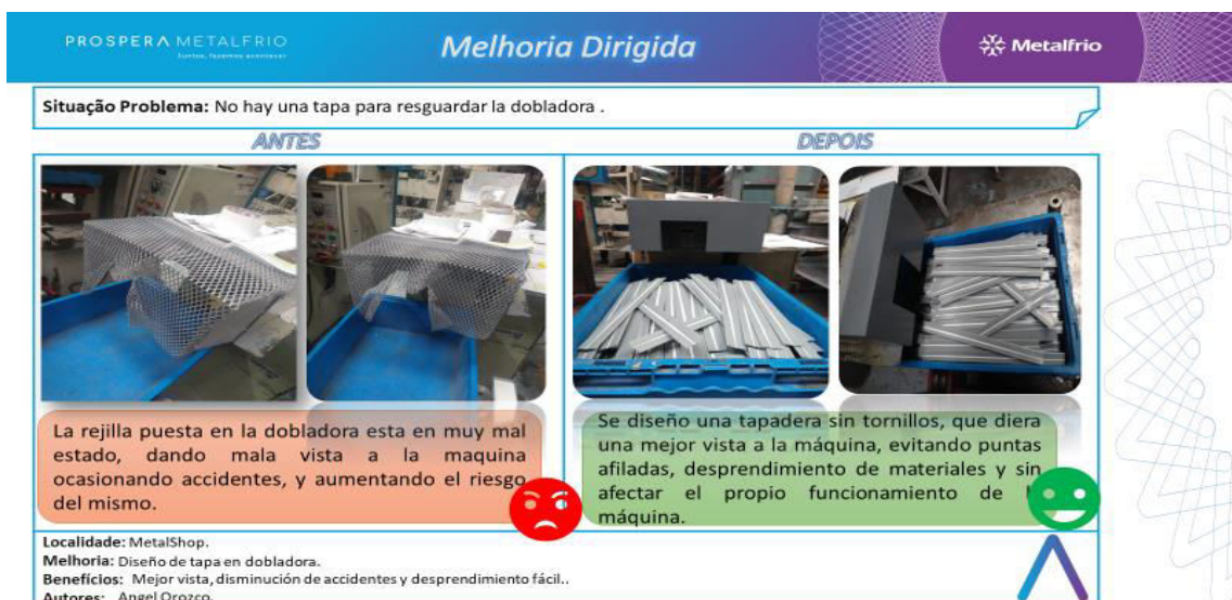
Ilustración 43. Tapa resguardadora en dobladora.
