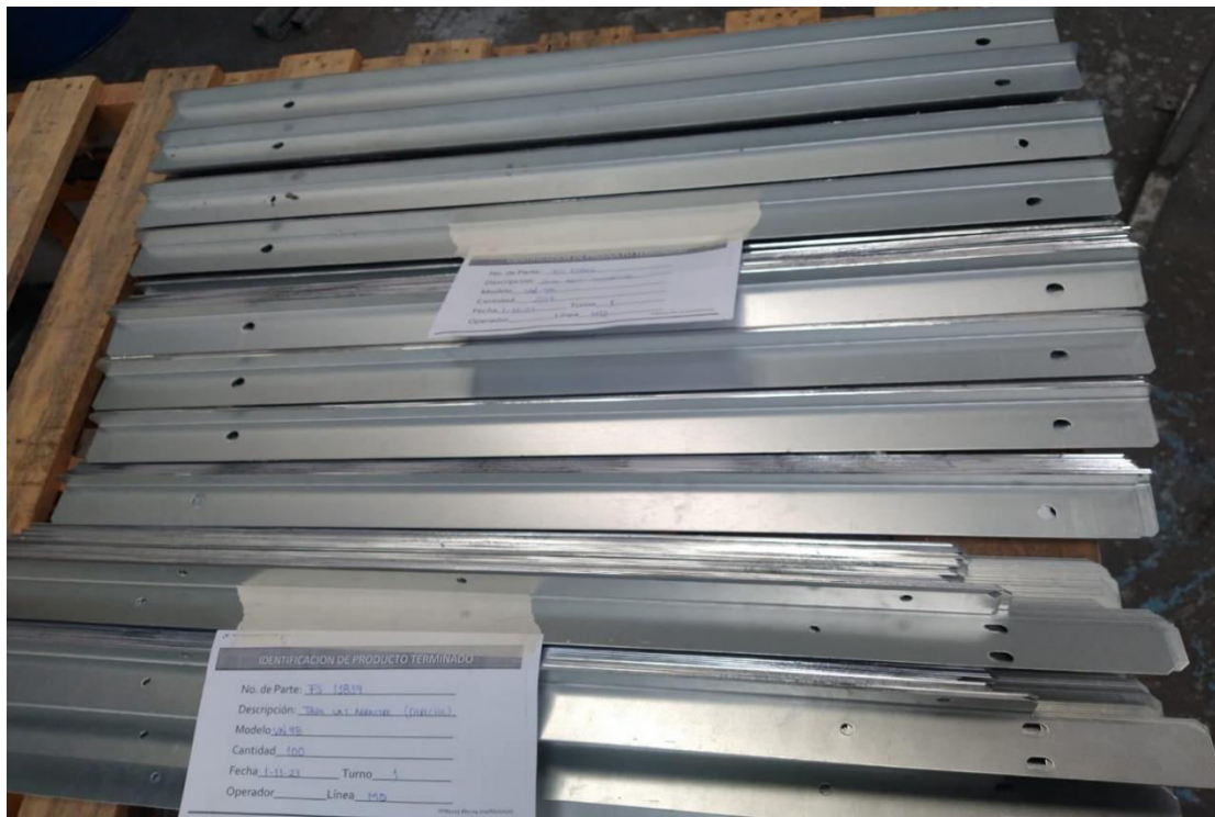
Ilustración 71. Guía para base compresora.
