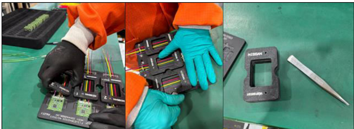
Ilustración 14 Retiro de la placa metálica tras la soldadura Fuente: Propia
