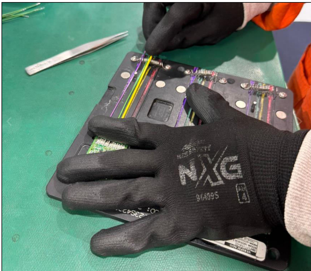
Ilustración 12 Colocación de cables en la pcb
