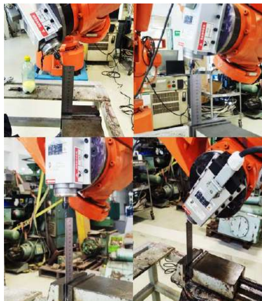
Figura A. 20 Calibración del TCP.
