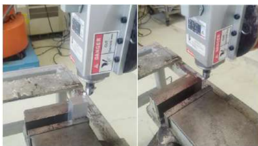
Figura A. 40 Posicionamiento del TCP en el origen programado.
