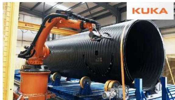
Figura 1.5 Operación de fresado mediante robot KUKA . [7]
