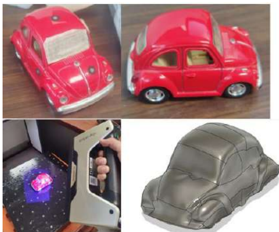
Figura 5.8 Modelo 3D de automóvil generado por escáner.
