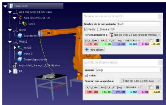
Figura A. 36 Configuración de los datos “Tool y Wobj”.
