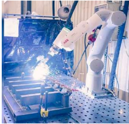
Figura 1.4 Operación de soldadura mediante robot ABB . [6]
