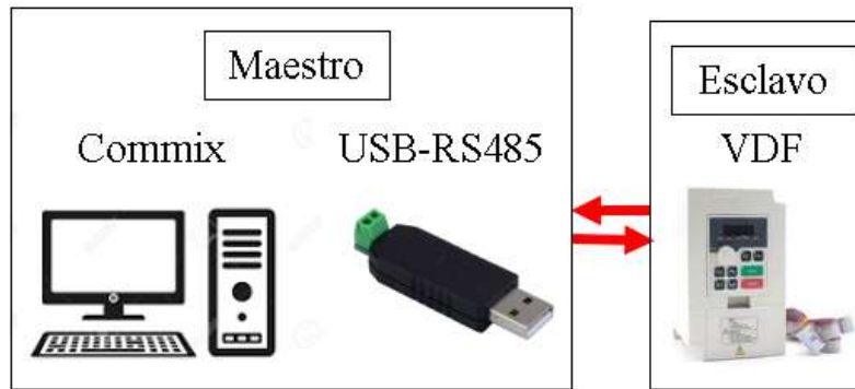
Figura 4.15 Proceso de envío de datos USB-RS485 .
